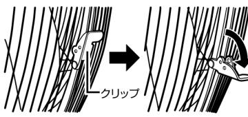
2 次に側面のクリップを全て解除します。
