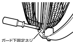
1 前ガードを取り外すには、ガード固定ネジをプラスドライバーで外します。
