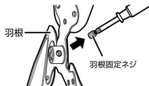
3 羽根中央部分の羽根固定ネジはプラスドライバーで緩めて、取り外します。
