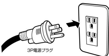
アース付3Pコンセントが無い場合は3P電源プラグのアースピンを折り曲げ、2P電源プラグとしてご利用いただけます。
