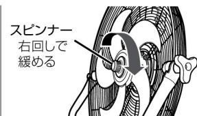
3 羽根はスピナー右回しで緩めて、取り外します。
