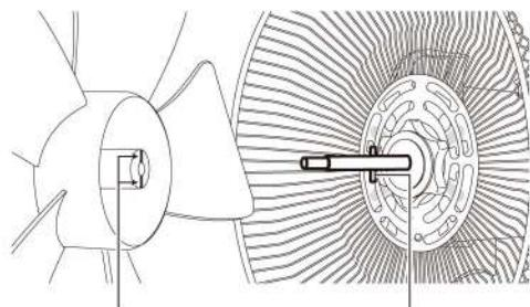
モーター軸のピンと羽根裏側中央の凹みを
